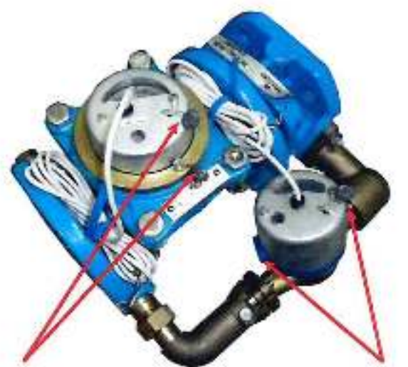
б) Счетчик холодной воды комбинированный ВСХНКд-50/20
